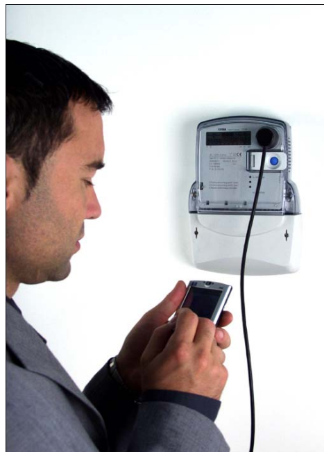
Fig. 6 – Сваляне на данни посредством Palm top PC
